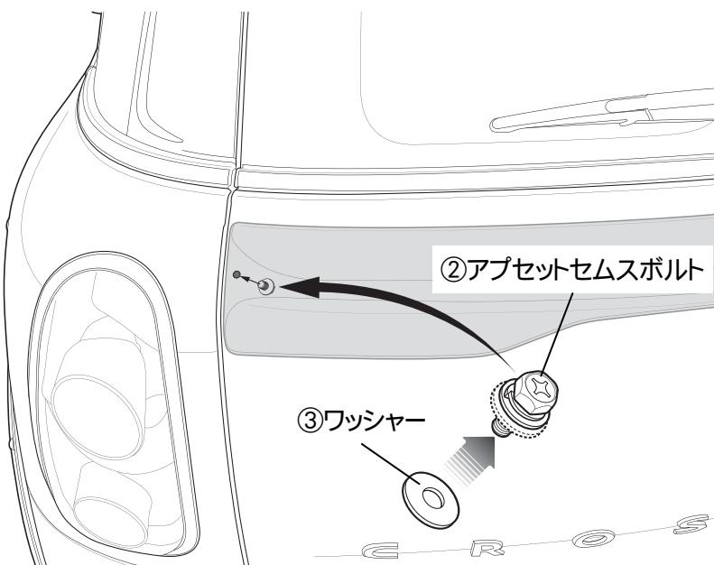
・②アプセットセムスボルトに③ワッシャーを組込んで、バックドア裏側の穴から①リヤハッチスポイラーを固定します。
