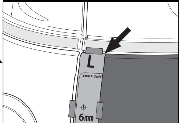
アドバイス ⑦型紙の上側合わせ位置は、拡大図の矢印が示すボディパネルとゴム部の境目に合わせてください。貼付け位置がずれたまま作業を進めると、製品を正しく装着できません。
