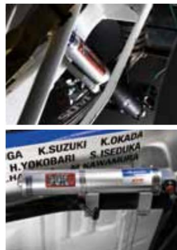
上:リヤは全長745mmものロングショックを装着するためにレイアウトを大きく変更。スミハツ製リーフスプリングはストリート用に再チューニングしてリフトアップキットとしてジャオスから市販される予定だ。
