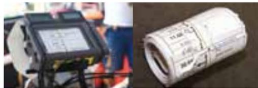
手元にあるスイッチでトリップメーターをリセットし、まるでトレイルペーパーのようなロール状のコマ図を送りながらルートを探して走る。コースはAUTOクラスと同じものだが、コマ図は部分的に省略されている。
