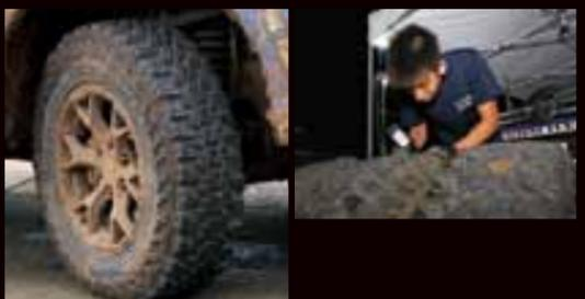
200km以上のSSで激しいオフロード走行をした後でもしっかりとブロックが残っている。オフロードでの高い耐久性が頼もしい。
