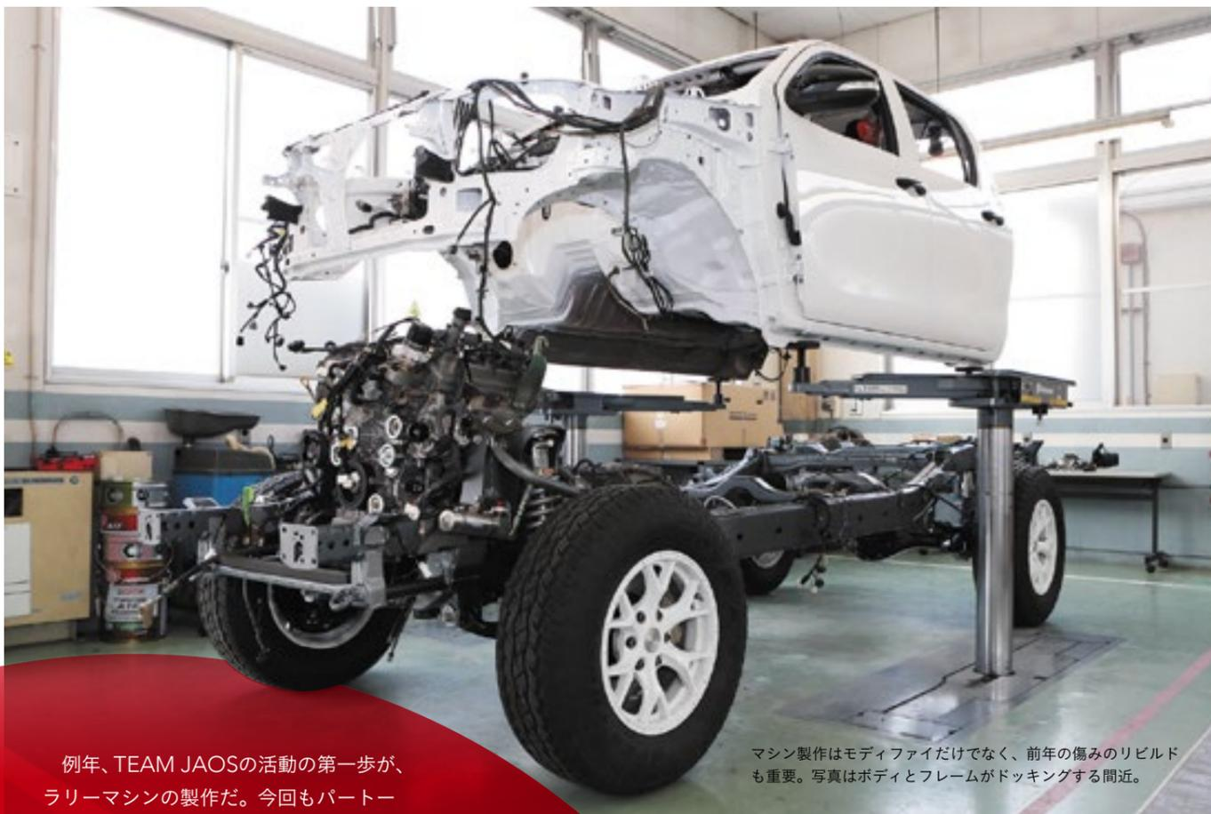
マシン製作はモディファイだけでなく、前年の傷みのリビルドも重要。写真はボディとフレームがドッキングする間近。
