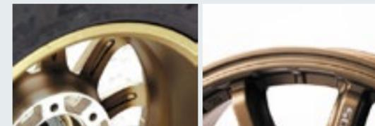
スポークのエッジやスポーク背面を肉抜きして、軽量化とスポーティさを表現。逆にインナーリムに配された段差のあるフィン形状のほか、ダブルリムフランジでワイルドなオフロードテイストを醸し出す。
