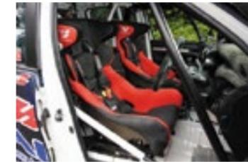
トヨタ紡織製のヘッドサポートを装備したフルバケットシート (FIA公認・非売品) を中心に、ラリーマシンらしいギアを搭載するコックピット。長時間の激しい走行でも体をしっかりと支えるシートのほか、幻感防止のダッシュシートやラリーコン用iPad、オクヤマ製ペダルなどで工夫。
