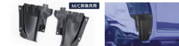
タイヤハウスに余裕がなく、装着できるタイヤ&ホイールの選択肢が少ないハイラックス125系。ワンサイズアップの大径タイヤ「17×8.0J17」やアウトセットにしたホイール「17×8.0J±0」などを装着した時の干渉を防ぐ加工を、スムーズに行えるお悩み解消アイテム。本体は自動車の純正部品に多く採用されるPP(ポリプロピレン)、3D CADによる正確な設計で自然な装着を実現。
