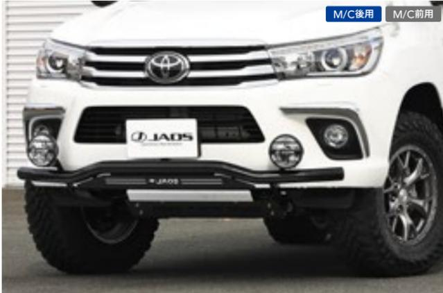
スマートにヘビーデューティさを与える、60.5φのステンレスバーを特徴とするフロントスキッドバー。一世を風靡した『JAOSスタイル』の人気アイテムを現代風にスタイリッシュに表現したもので、定番の人気を誇る。ワイルドな見た目になるのはもちろん、フロントバンパーを障害物から保護できるのも魅力だ。バーとプレート部の組み合わせで全4パターンを用意。さらに、フォグランプの装着ができる補助ランプ用ブラケットを標準装備。
