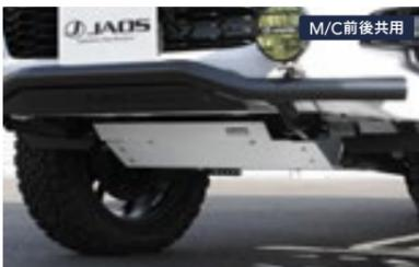
AXCRラリー参戦マシンのパーツ開発からフィードバックされたスキッドプレート。本体は高強度と軽量を兼ね備えた4mm厚のアルミ製で、オフロード走行でうっかりヒットさせてしまうフロントボトムをしっかりとガードする、頑丈なプロスペックモデル。
