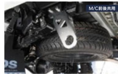
アウトドアアクティビティでの道具の固定にも重宝するドレスアップを重視したタイダウンフック。素材に錆や腐食に強い高品質な9mm厚のステンレスプレートを採用。ショットプラストと電解研磨を施すことで、傷が目立たないタフネス仕様。
