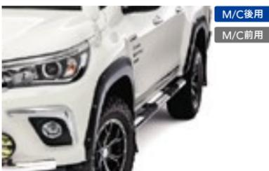
スパルタンなデザインによって、サイズ以上に存在感をアピールするフェンダーガーニッシュ。車体へボルト留めしたように見える部分は、ボルトヘッドをイメージしたオリジナルダミーボルト。フェンダー表面に穴開けの必要なく装着可能。
