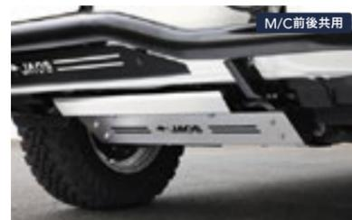
思わぬダメージを受けやすいフロントボトムをしっかりとガード。また、リフトアップ時のドレスアップアイテムとしても効果的な見た目を発揮する。表面にはショットプラスト+電解研磨を施すことで、傷が付きにくい(目立たない)タフネス仕様となっている。
