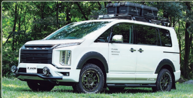
JAOS オーバーフェンダー type-X 【装着時寸法】片側：+25mm(全幅：+50mm)
