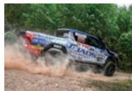
ハイラックス・レボを2台揃え、そのうち1台はリアサスを4リンクのコイルリジッドに改造。最新・最強のサスペンションと地元タイ選手の起用で必勝のワークス体制で臨むTRDチーム。リアのハブボルト回りのセッティングが同じため、諸々ヒアリングさせていただいたが、同じトラブルは出ていないという。
