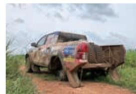
左後輪のハブボルトが6本とも折れ、走行不能になった。この後、左前輪のハブボルトを3本抜き、左後輪に移植する応急処置で切り抜けた。
