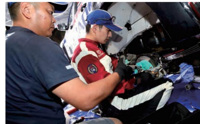
破断したハブボルト部の修理を行う今泉と高見澤。スペアパーツとして持って来ていたため、マシンがホテルのピットまで戻りさえすれば修理は可能だった。開始時刻が遅く、夜遅くまでかかってしまったが他に外傷もトラブルもなく、翌朝には完璧な状態まで復帰した。
