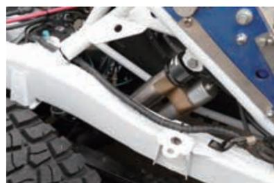
減衰力調整機構付きで圧側はピストンスピードの低/高速に分けた調整が可能だ。高強度アルミ材で造られたオイルのリザーバタンクはダンパー本体に並列で直付け、フロントはステンメッシュホースを介して取り付けられる。リアはマウントの位置を変更して取り付けられている。
