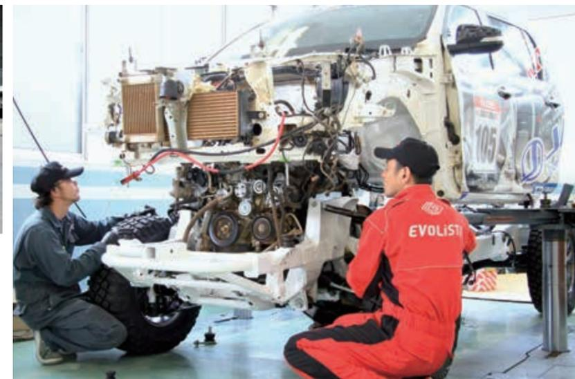
フレームにエンジンや駆動系、サスペンションなど全ての部品が取り付けられた後、ボディを乗せたリフトまで手押しで移動した。ボディとフレームのドッキングは準備作業後半のハイライト。スタッフは手慣れたもので、ハンドルを切りながら前後に動かすことでしか位置調整のできないシャーシをボディの下に素早くセットして、あれよあれよという間にドッキングしてしまった。これにて群馬トヨタ自動車高崎インター島野店・サービス部研修センターでの作業はほぼ終了し、後日ジャオス本社に移動した。
