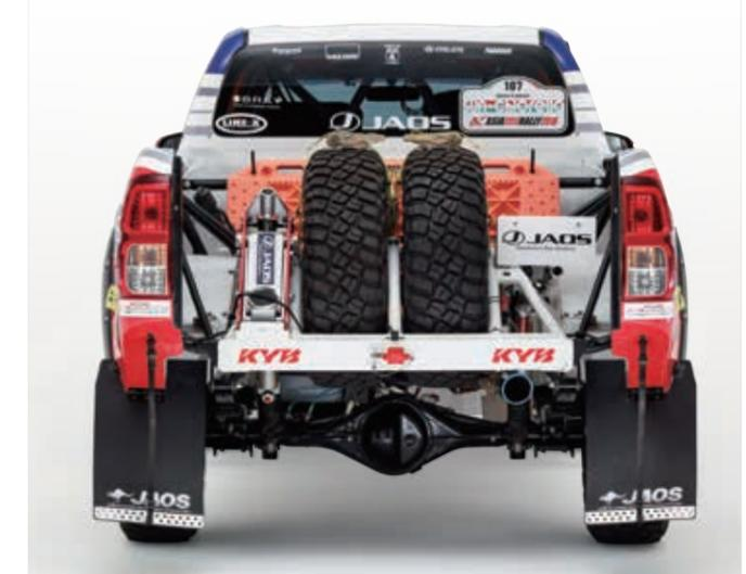
拡幅されたフロントのトレッドに合わせて、リアのトレッドも広げられた。フロント同様フェンダーパネルが横に大きく張りだしたものに交換され、より安定感の増した姿に生まれ変わっている。
