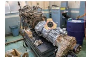
ラダーフレームは全てのパーツが取り外されフレーム修正を受けた後に塗装された。ラッピング前のボディも細かなところで塗装整備を受けている。6MTのミッションは新しいものに交換され、クラッチプレートはセラメタ製の強化タイプがインストールされた。
