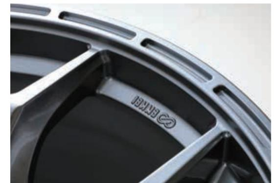
鋳造工程後、リム部を鍛えながら引き伸ばして成形する ENKEI 独自の MAT PROCESS 製法により、リムに鍛造に匹敵する材料強度を与えつつ、鍛造では成形不可能なディスクデザインが実現できる。センターに向かって落とし込まれた立体感ある形状を採用し、リムやスポークのデザインも細部までこだわった渾身の作だ。ラリーマシンに履かせたのはガンメタリック。
