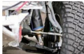
ジャオスとKYBの共同開発プロジェクトの一環として新たに設計された新型ダンパーは5月8日のシェイクダウンでお披露目された。コイルスプリング自体を車体から切り離す完全コイルオーバー化を果たしている。詳しくは30ページを参照。
