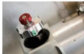
KYB製のスペシャルダンパーは前後ともにリザーバタンク付きで、伸び側/圧側ともに減衰力の調整が可能。数種類のスプリングを交換しながら減衰力のマッチングを図るバズルのような作業が始まった。
