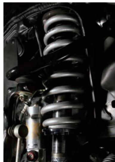
前後ともにリザーバタンク付の減衰力調整式ダンパーが用意される。フロントは車高調整機能付き。プラド150用はフロント10~50mm/リア35~40mmのリフト量。FJクルーザー用はリフト量の違うver.Aとver.Bが用意される。また、プラド用にはローダウン用のキットもある。
