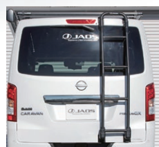
軽量アルミ製ラダー JAOS リヤラダー-AL
