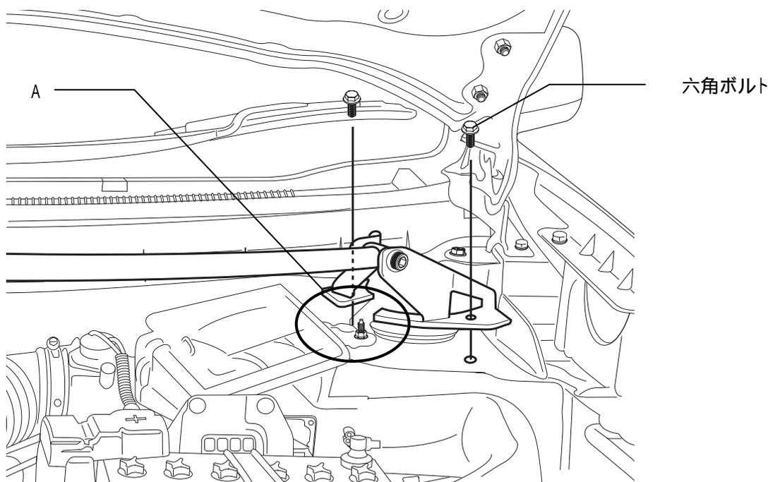
エンジンルーム内よりストラット固定部のボルト片側2ヶ所、左右計4ヶ所を外し、アルカーボンタワー本体を六角ボルト(純正ボルトと交換)にて固定してください。
