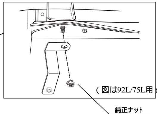
[2] 図2-B部の純正ナットを利用してブラケットA (60Lは )を取付けてください。
