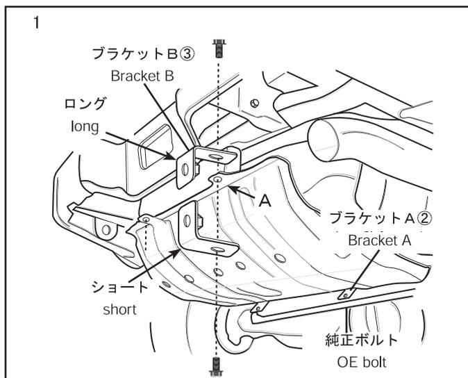
[1] 純正タンクガードリヤ側A部のボルトを外し、純正ボルトを利用してブラケット B を共締めしてください。
