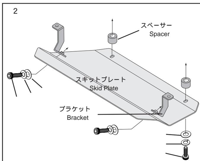
[2] 純正アンダーガード後側のボルトを外して、スキッドプレート と純正アンダーガードとの間にスペーサー を差し込んで六角穴付きボルト .スプリングワッシャー .平ワッシャー を使用して仮止めしてください
