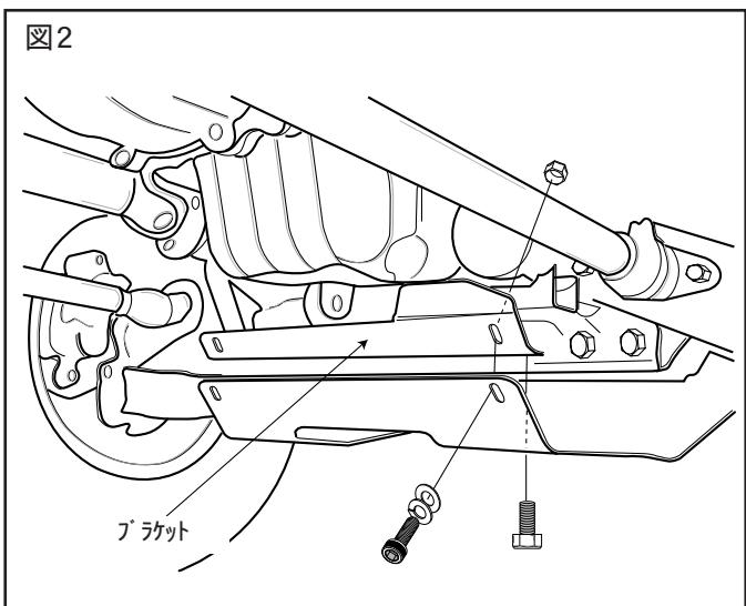
純正アンダーガードを外し、その取付け部(リヤ側)を利用してブラケット(9)を取り付けてください。
