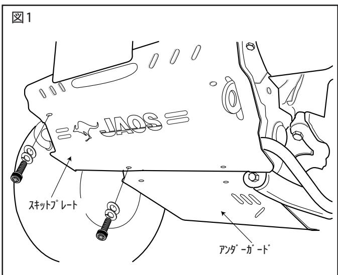
純正ガードを外し、その取付け位置を利用してスキットプレート本体(1)を取り付けてください。
