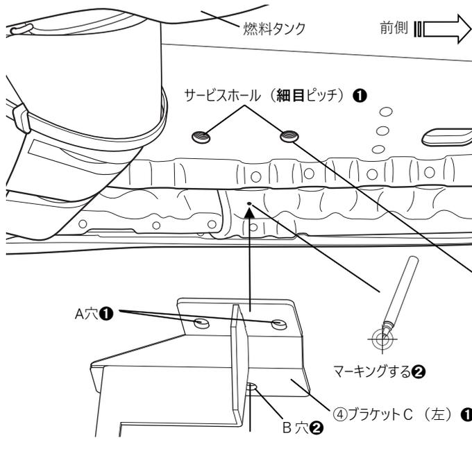
・ブラケットC④のA穴とサービスホール合わせ、六角ボルトM10-20細目⑥にて仮止めします。(①)
