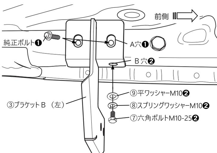
・ブラケット B ③を A 穴と純正ボルト取り付け穴を合わせ、純正ボルトにて仮止めします。(①)
