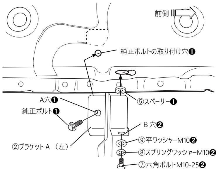
・ブラケット A ②にスペーサー⑤を載せ、A 穴と純正ボルト取り付け穴を合わせ、純正ボルトにて仮止めします。(①)
