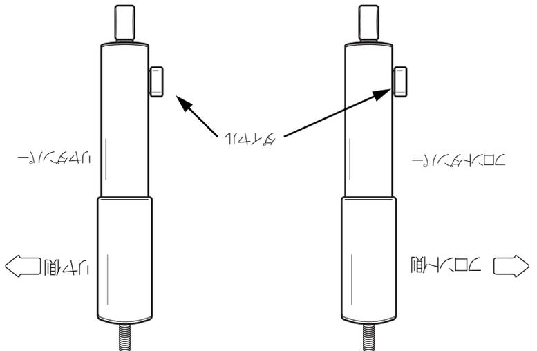
減衰力調整用ダイヤルの向きによってサスペンションアームに干渉する場合があります。下図を参照し、ダイヤルの向きを厳守してください。
