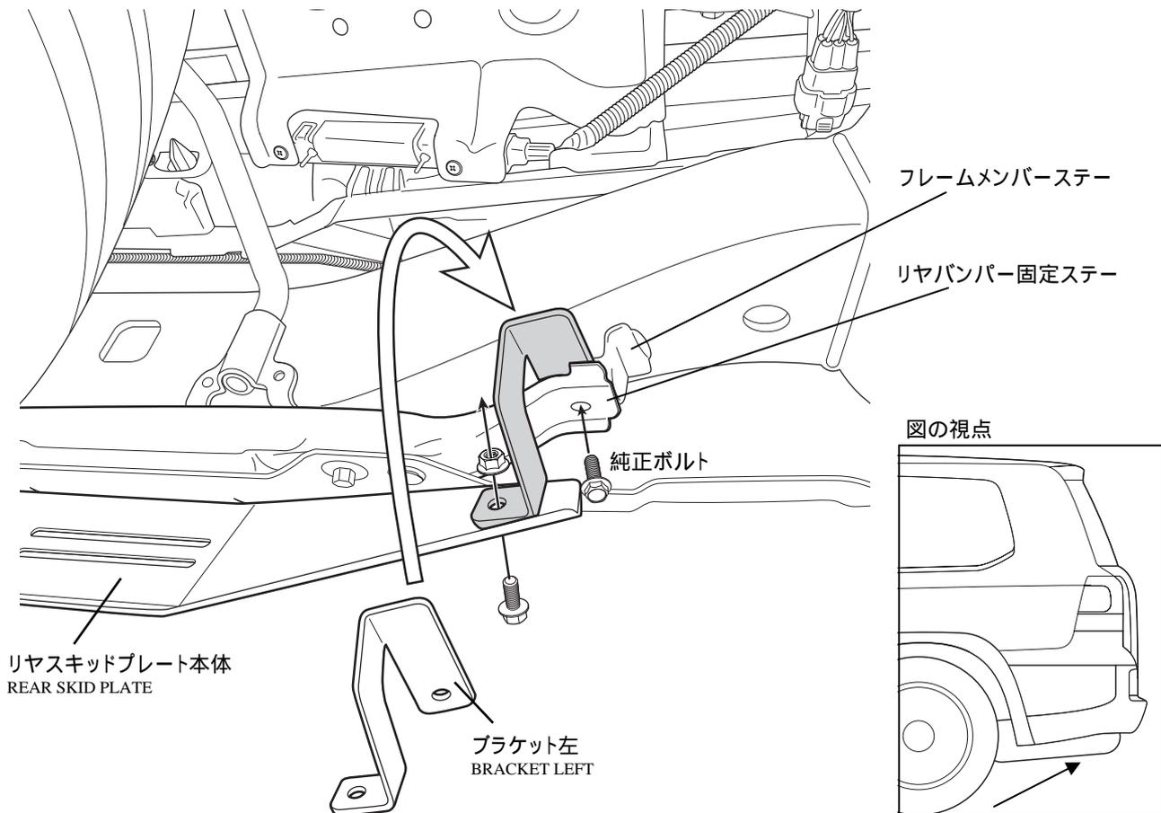
1. リヤバンパー固定ステーの純正ボルトを外して下さい。(上図参照)
