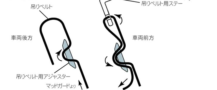
3. 吊りベルトの長さを決めカットします。参考吊り長さ: 約22cm
