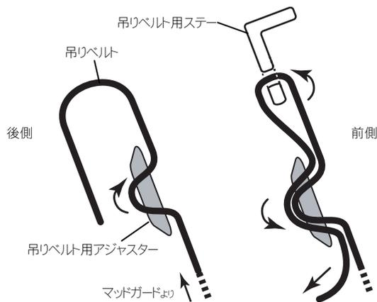
2. 吊りベルトの長さを決めカットします。
