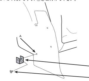
1. フロント側マッドガードA部フロント用ブラケット①を使用します。純正クリップを利用して取付けて下さい。
