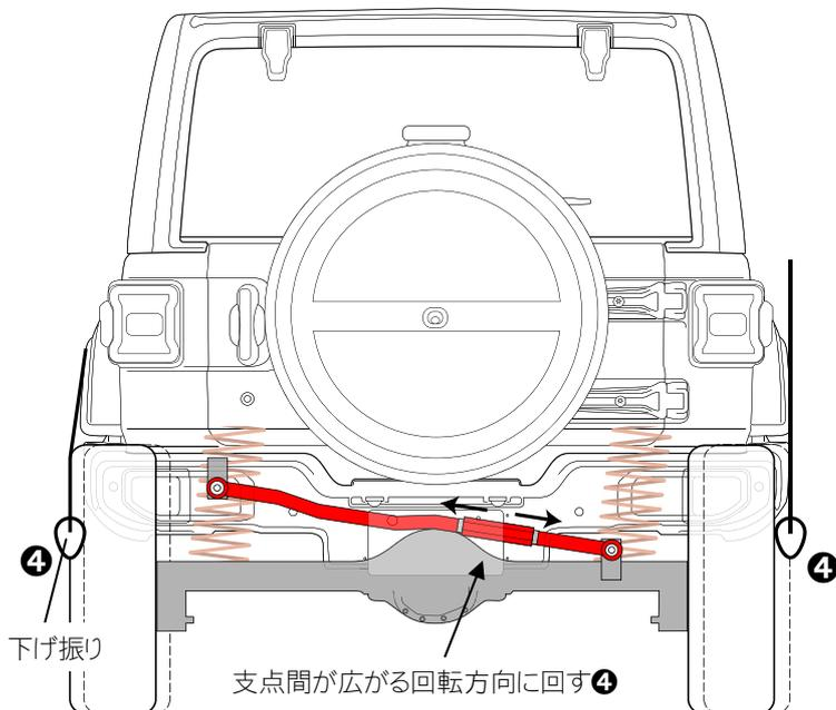
・ナット④を緩め、ターンバックル③を調整できるように準備します。(①)
