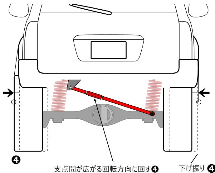
**アドバイス** ターンバックル③を回し、支点間が広がる回転方向、狭まる回転方向を確認しておくと、後の調整が楽になります。
