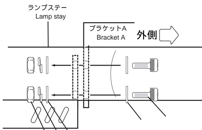
[5] 取り付けたブラケットA にランプステーを六角穴付きボルト .平ワッシャー .スプリングワッシャー .六角ナット を使用して仮止めしてください
