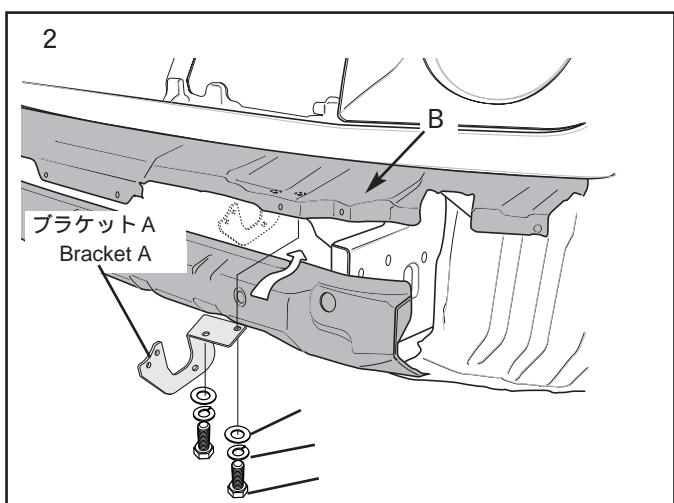
図2は取り付け状態を示すためフロントバンパーを外した状態になっていますが、図2B部はフロントバンパーと一緒に外れますので[1]の作業の後同時にやってください
