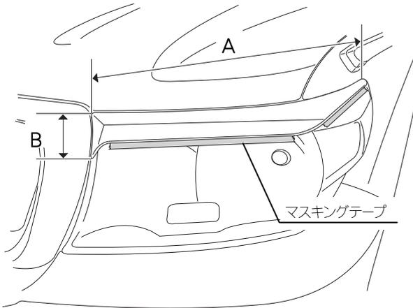
1. ヘッドライトガーニッシュ①を一度ヘッドライト部にあてがって、取付位置とフィッティング、また両面テープ接着面の位置を確認する。
