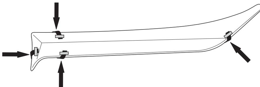
1. ヘッドライトガーニッシュ①に貼り付けた両面テープの離型紙を一部剥がし、表面に折り返してマスキングテープで貼り付ける。
