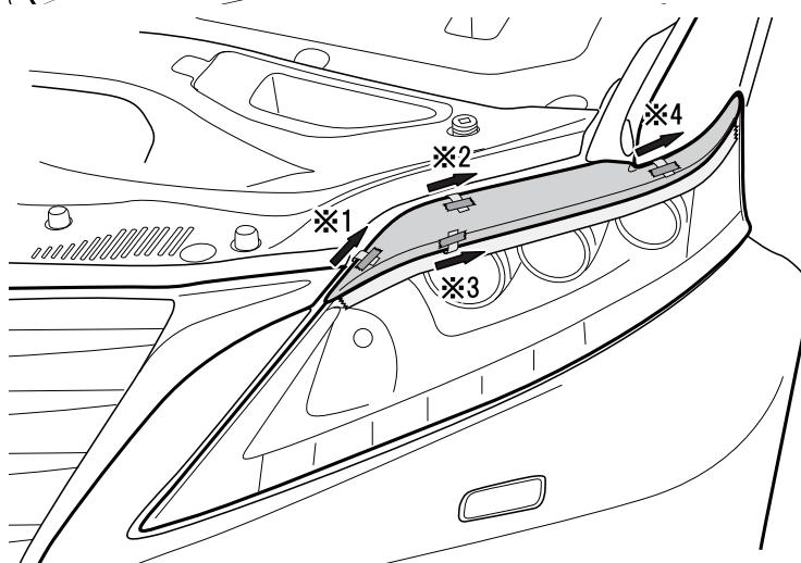
2.左図の※1から順に両面テープ離型紙を引き抜きながら圧着する。
