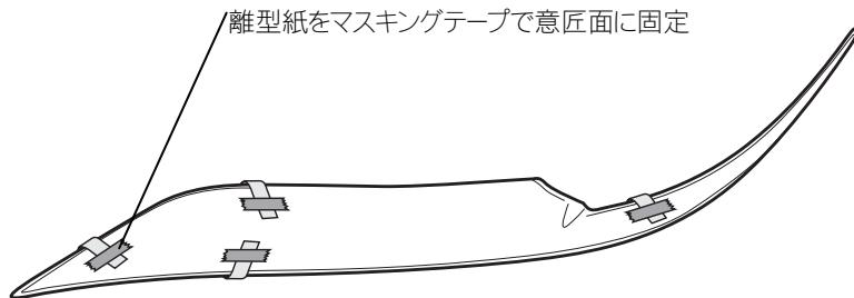
1.ヘッドライトガーニッシュ①に貼り付けた両面テープの離型紙を一部剥がし、表面に折り返してマスキングテープで貼り付ける。
