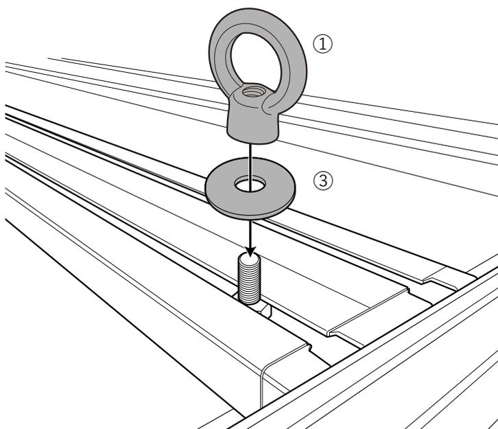
・フロアバーに取り付けた六角ボルト②にアイナット①ワッシャー③を取り付けます。 **推奨締付トルク 2~4N・m**
