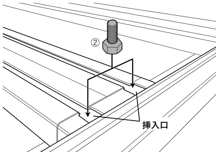
・フロアバーのエンドキャップにある挿入口に六角ボルト②をはめ込みます。
