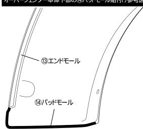
(1) 注意 エンドモールの取付け面は必ず間違えないように注意してください。 左図を参考に両面テープの幅が"狭い"方を製品に取付けます。 間違えた場合、製品が正しく装着できません。
