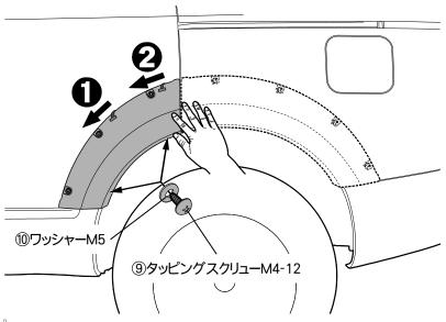
アドバイス 離型フィルムを引く抜く際に、オーバーフェンダー本体の取り 付け位置が変わらないように注意してください。
