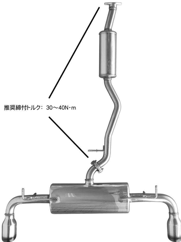
・バンパー側から見たテールの位置関係をパイプサポートや各フランジ部の合わせなどで調整しながら、仮組みした箇所をボルト類を増し締めします。
