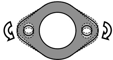
**⚠ 注意** ボルト類を締付ける場合は2点を交互に締付けるようにして下さい。偏った増し締めをするとガスケットがうまく密着せず、排気漏れを起こす原因となります。
