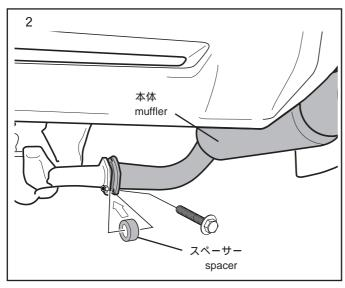
[3] 図2のようにマフラー本体 と純正マフラーを合わせて-六角ボルト を使用して固定しますが、その時にスペーサー を互いのフランジ間に差し込んでください
