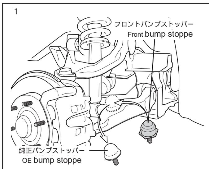
[1]フロントの純正のバンプストッパーを外して、フロントバンプストッパー を純正と交換する形で取付けてください
