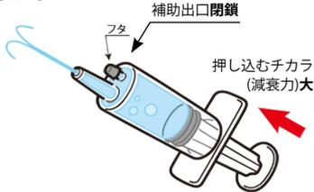
前出の注射器で説明すると図6のようになります。減衰力が低ければ、バネの動きを阻害しないので、衝撃を柔軟に吸収する事が出来ます。逆に、コーナリング時などの周波数の低い(大きくゆっくりな動き)の時は、ロッドから流れ込むオイルの流力が強まり、押し下げられた可動ピストンが可変オリフィスを閉じて減衰力が高まります(図7)。注射器で説明すると図8のようになります。減衰力が高まれば、バネの無駄な動きを押さええて高速走行時の車両挙動を安定させる事が出来ます。かなり大雑把ですが、これがハーモフレック®の仕組みと役目です。
