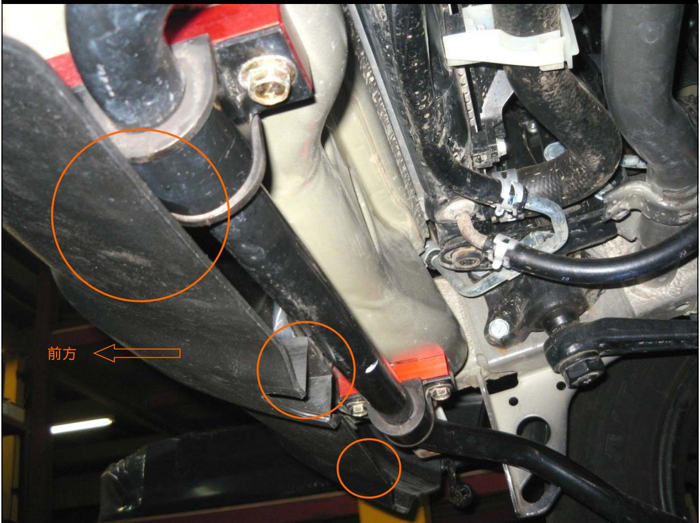
スタビライザーマウント部へダウンプロックを取付けますと、上記箇所が純正バンパーに干渉してしまいます。干渉する箇所のバンパーをカットします。
