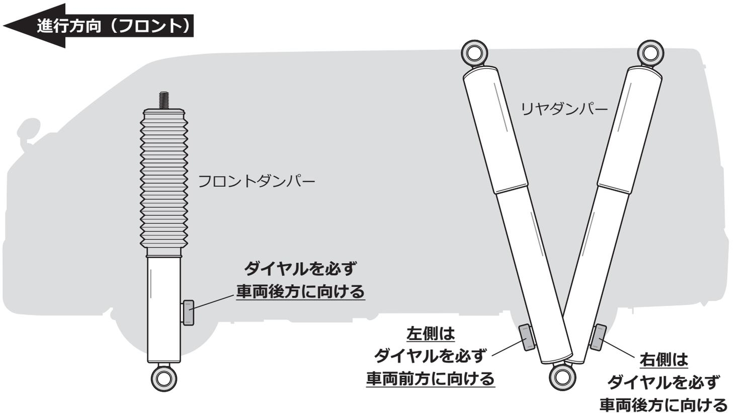
**注意** 減衰力調整用ダイヤルを必ず図と同じ向きにして製品を取り付けてください。誤った向きで取り付けるとサスペンションアームに干渉するおそれがあります。危険です。
