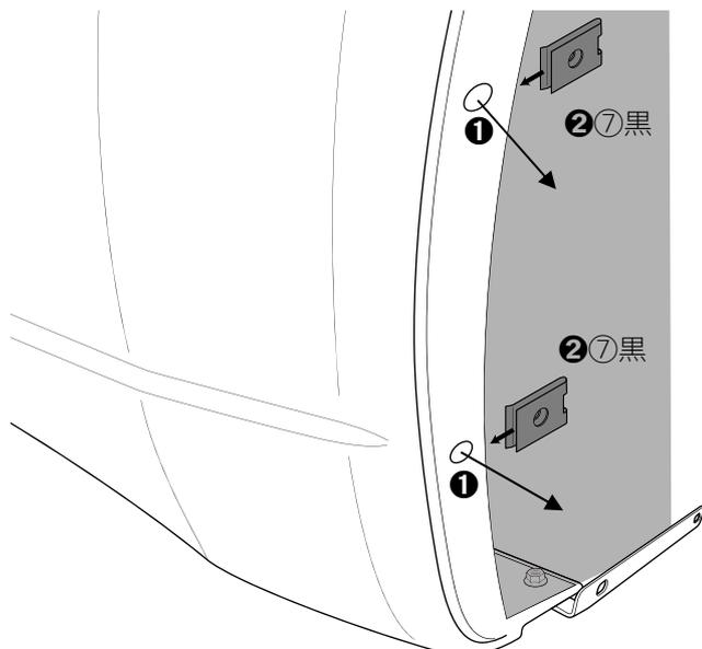
・純正インナーカバーとリアバンパー縁を固定しているクリップ2ヶ所を取り外します。(①)
