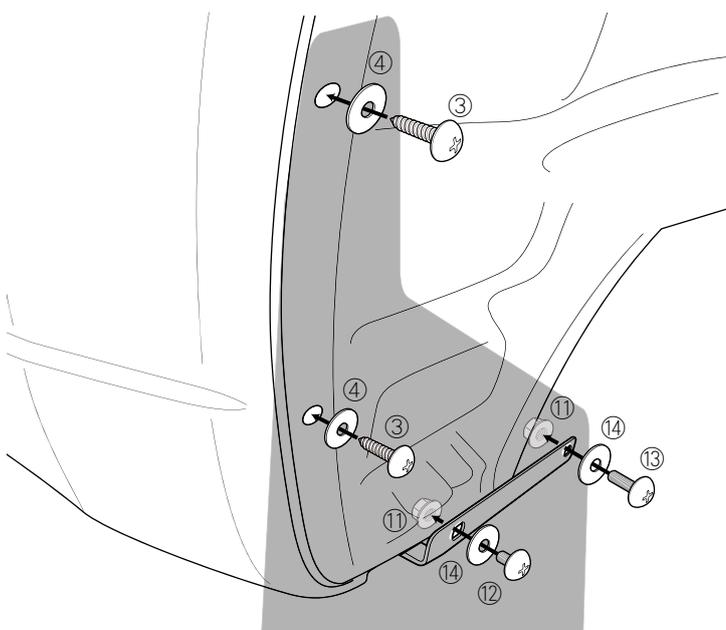
・純正インナーカバーを元の位置に被せ、上から順番に付属のビス類を使用し仮組みして行きます。
