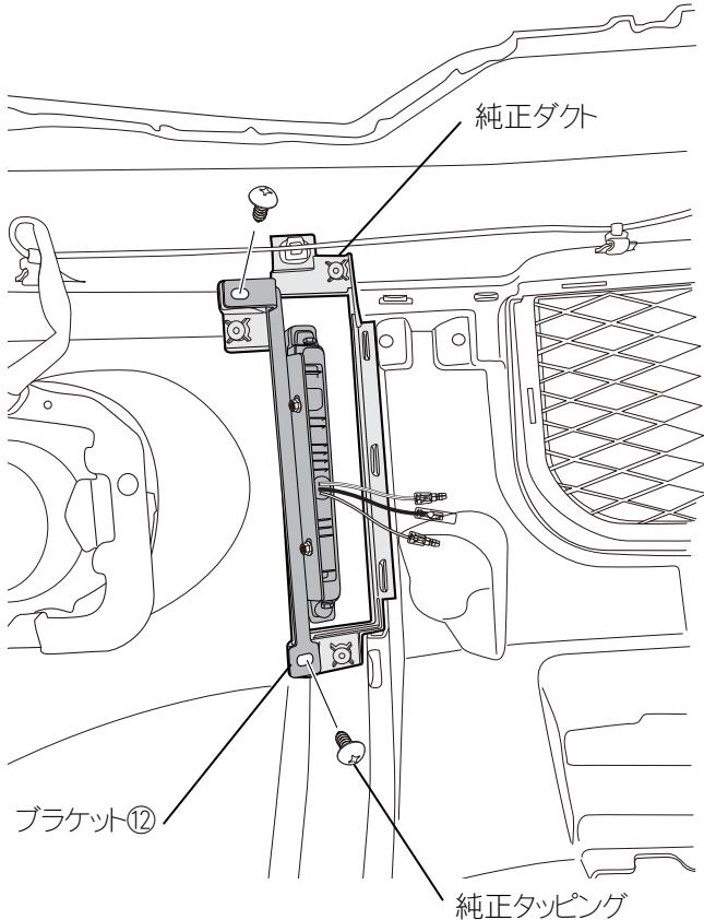
6.電源ハーネス②/ポジションハーネス③/アースハーネス④をデイランプ本体①の配線に接続して、点灯確認の後、純正バンパーを取り付けします。
