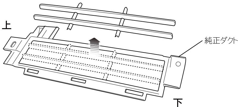
5.下図のように加工した純正ダクトとブラケット⑫を純正タッピングで固定します。
