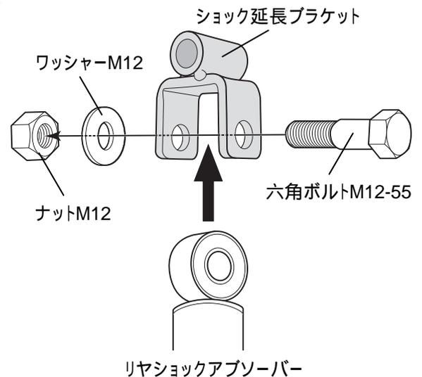
・上図のように ショック延長ブラケットの間にショックアブソーバーを挟み入れ、六角ボルトM12-55及び ワッシャーM12、ナットM12で仮固定します。
