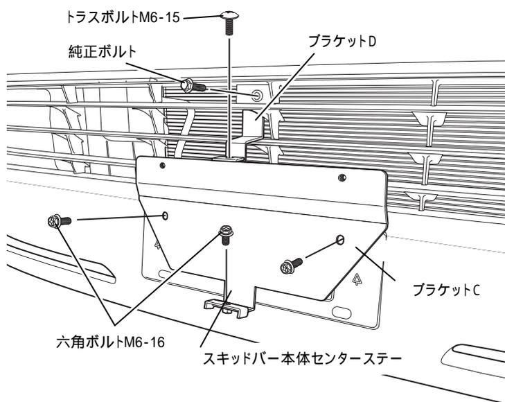
4. バンパースリットの中央にある純正ボルトを外して、バンパースリットとナットステーの間に Bracket D⑤を挟み純正ボルトにて共締めしてください。
