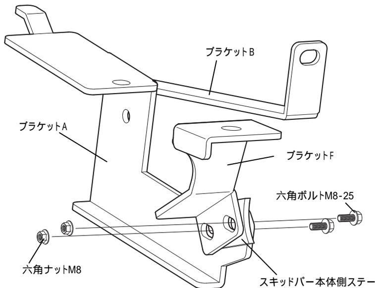
3. スキッドバー本体①のステアと Bracket A ②を六角ボルトM8-25⑨・六角ナットM8 ⑩で仮止めしてください。
