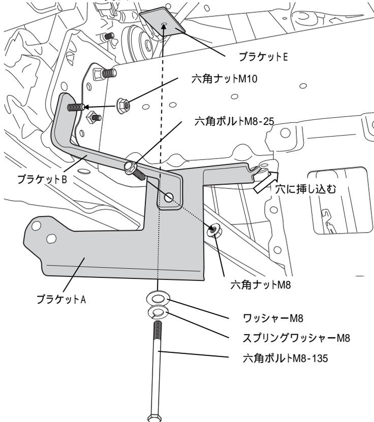
1. フロントバンパー裏側フレーム部の穴を利用しブラケットA②の爪を左図の位置へ挿入します。爪と反対側にあるボルト穴には六角ボルトM8-135⑧・スプリングワッシャーM8⑩・ワッシャーM8⑪・ブラケットE⑥を使い、ブラケットA②とフレームを挟む様にし仮止めします。
