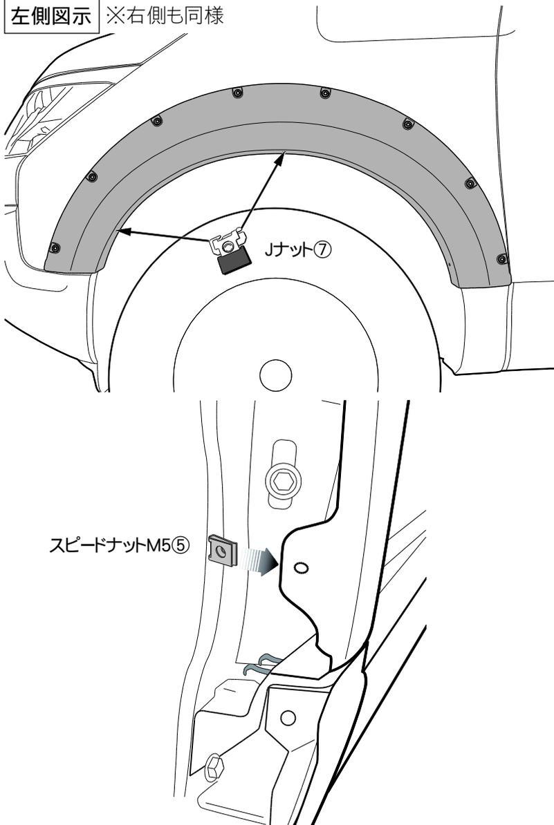
・フェンダーガーニッシュ本体（フロント）①を車体にあてがい、取り付け穴に合わせてJナット⑦を車体フェンダー部に取り付けます。
