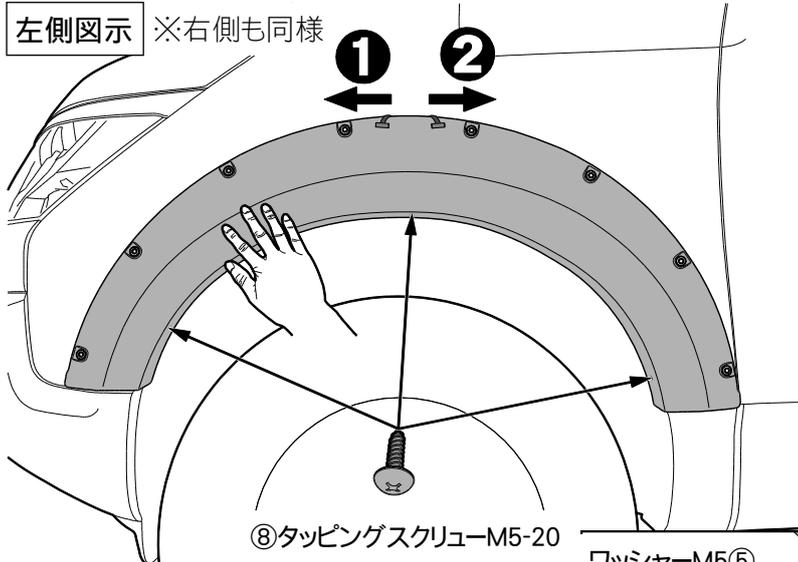
**アドバイス** 右図のようにマッドガードを同時装着する場合は、スピードナットM5⑤の固定箇所にはワッシャーM5 (ブラック) ⑩を図のように使用してください。
