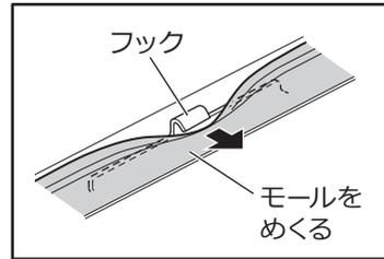
□図のように、各フック部の左右に保護シート⑮を貼り付けます。
