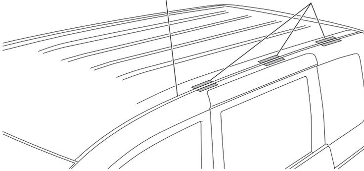
□車両のレインガターのモールをめくり、フックの位置（片側3箇所）を確認します。
