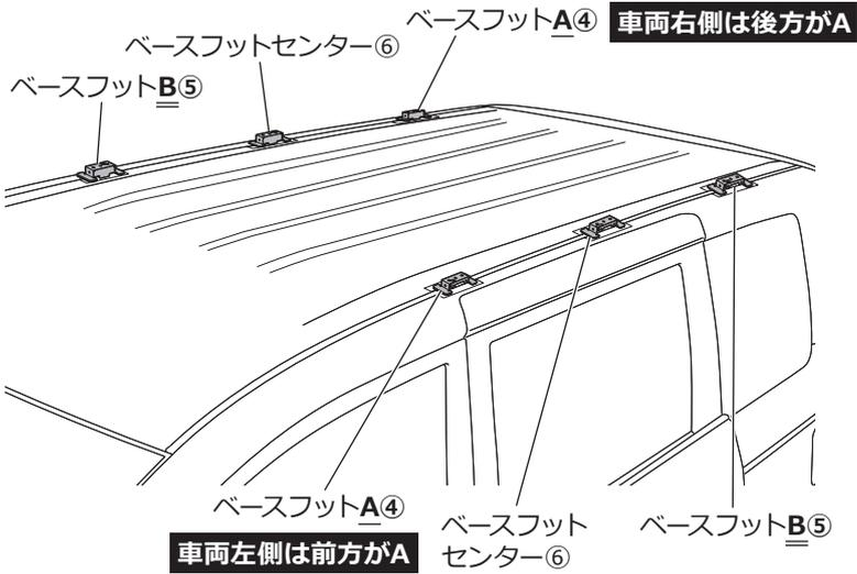
□ベースフットブラケット⑦にベースフットA④、ベースフットB⑤、ベースフットセンター⑥を組み合わせて、アプセットセムスボルト (M6×30) ⑫を使用して仮締めします。
