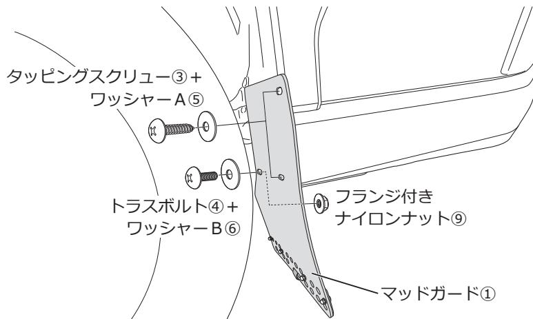
□マッドガード①の固定穴をブラケット②とスピードナットA⑦、B⑧の穴位置に合わせてあてがい、図のように部品を使用して仮組みします。
