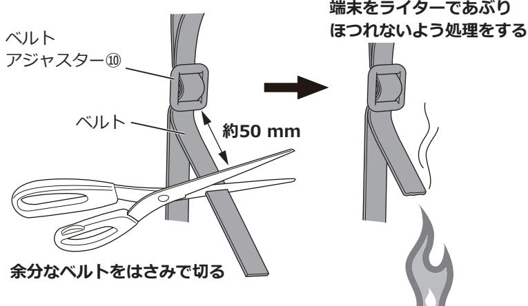
□ベルトの余りを約50 mm残して、不要な部分をハサミでカットします。
