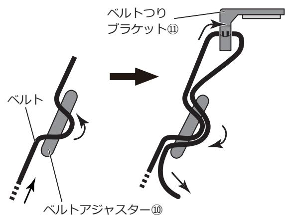
□マッドガード①のベルトがたるまない程度に調整し、左右のバランスを整えます。
