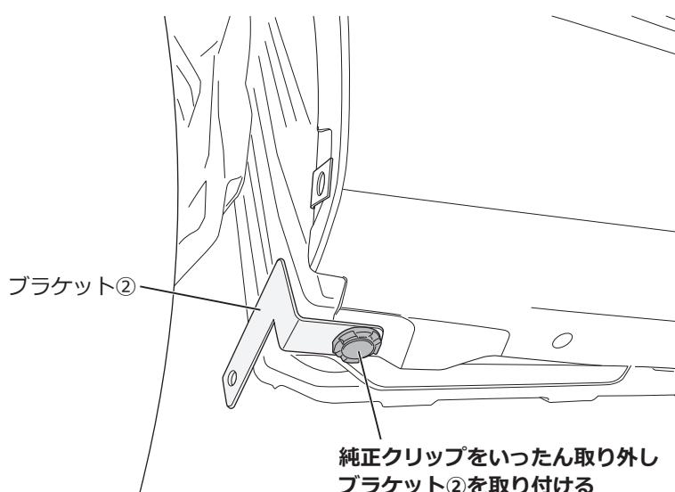
□タイヤハウス後方下側の純正クリップをいったん取り外しブラケット②を図のようになてがい、純正クリップで取り付けます。
