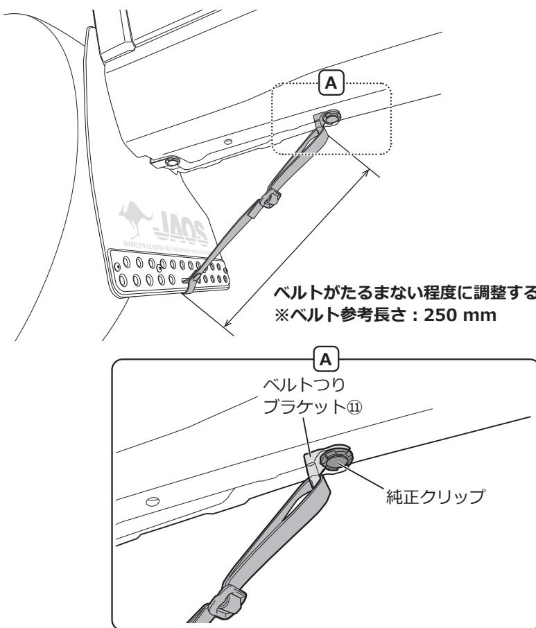
□図Aの位置にある純正クリップを使用して、ベルトつりブラケット⑪を車両フレームに固定します。
