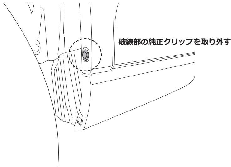
□タイヤハウス後方の純正クリップ（破線部）を取り外します。
