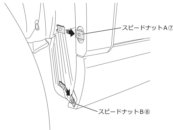
□フェンダー内側の穴位置に合わせてスピードナットを取り付けます。
