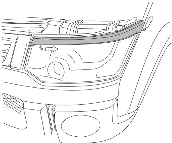
1.ヘッドライトガーニッシュ の取付け状態を確認し、残っている両面テープの離型紙を矢印の方向にゆっくり剥して下さい。
