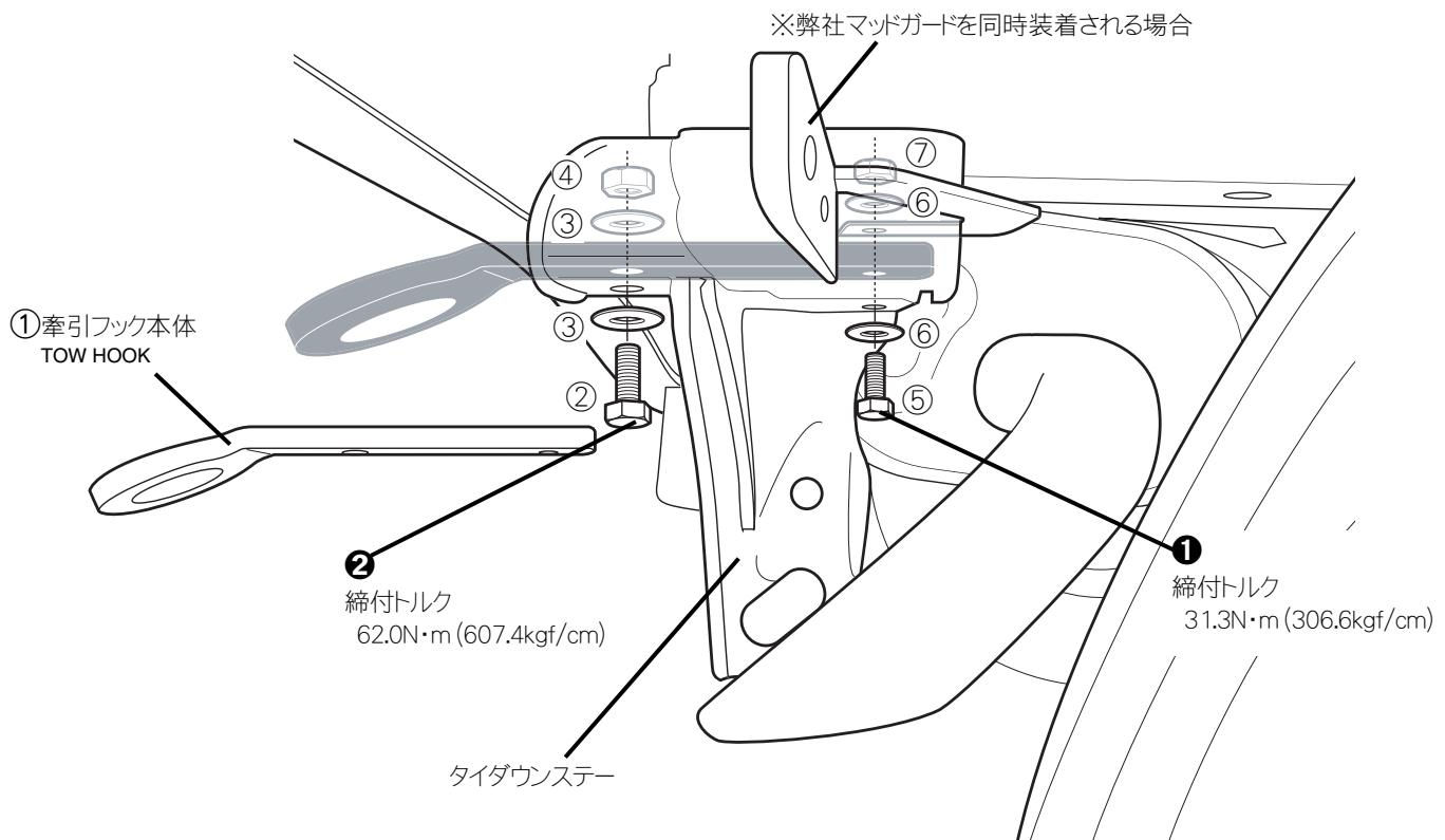
・牽引フック本体①をタイダウンステー付根の穴に挿入し、タイダウンステー付根にあるサービスホールを使用しボルト類を仮止めします(上図参考)。
