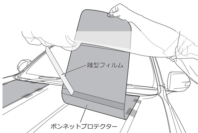
□中央部の細い離型フィルムをすべてはがし、固定した位置がずれないようボンネットに貼り付けます。
