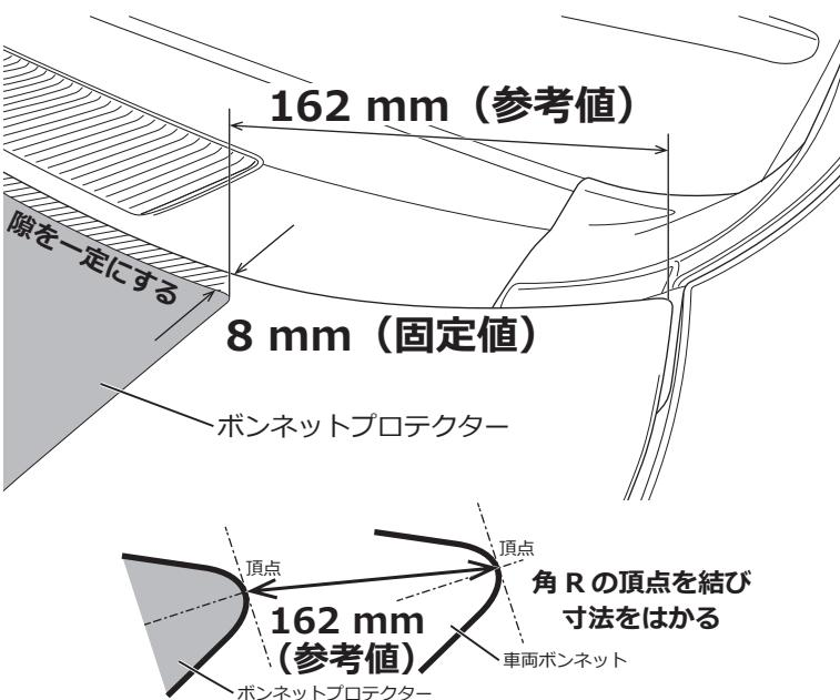
□図を参照し寸法をはかり、ボンネットにボンネットプロテクターを配置し、前後左右のバランスを整えます。
