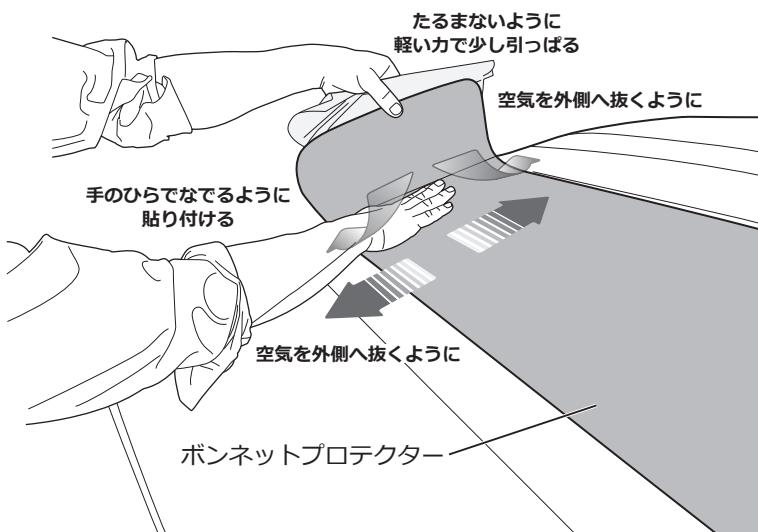
□貼る方向の端部を軽い力で少し引っぱりたるまない状態にしながら、接着面の上から手のひらでなでるように貼り付けます。
