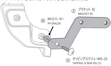
・下部のスピードナットB49を挿した箇所にPPスペーサー ⑤とブラケット②をあてがい、タッピングスクリューM5-25⑪で固定します。
