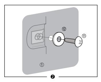
②取り付け穴にマッドガード①→ワッシャーM5⑫の順に 重ね、タッピングスクリューM5-25⑪で固定します。
