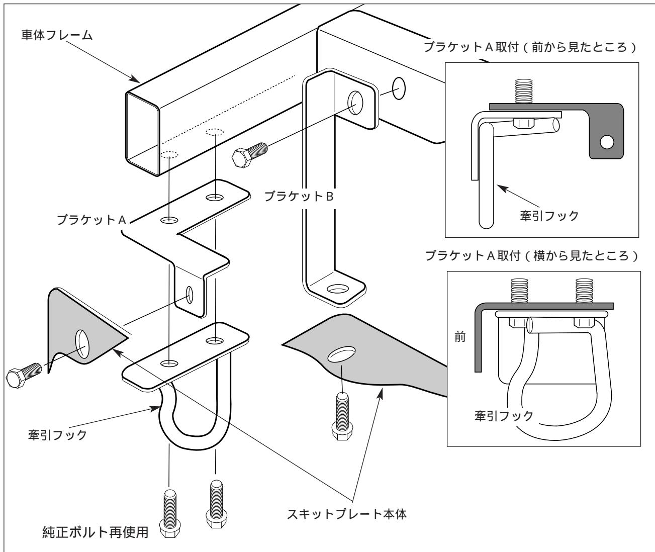
[1]牽引フックを外して、ブラケットA(2)を純正ボルトを再使用して牽引フックと共に締めしてください。
