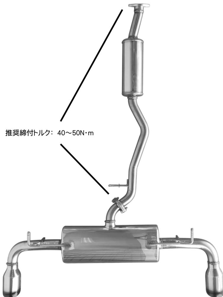
・バンパー側から見たテールの位置関係をパイプサポートや各フランジ部の合わせなどで調整しながら、仮組みした箇所のボルト類を増し締めします。
