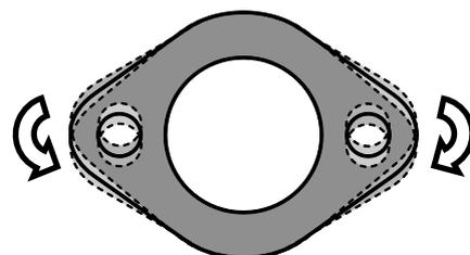
**!** **注意** ボルト類を締付ける場合は2点を交互に締付けるようにして下さい。偏った増し締めをするとガスケットがうまく密着せず、排気漏れを起こす原因となります。
