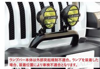
ランプバー本体は外部突起規制不適合。ランプを装着した場合、装着位置により車検不適合となります。
