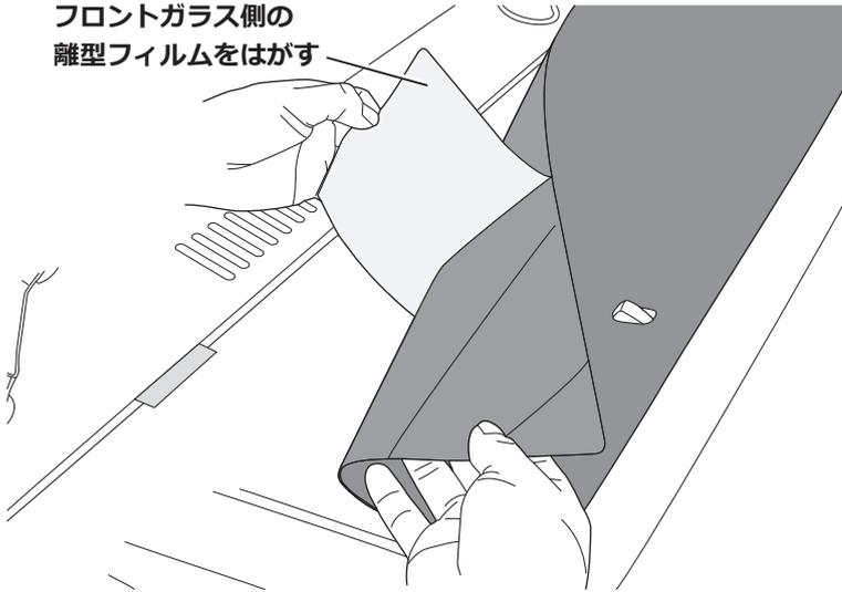
□フロントガラス側の離型フィルムをすべてはがし、貼る方向の端部を軽い力で少し引っ張りたるまない状態にしなが、接着面の上を手のひらでなでるように貼り付けます。
