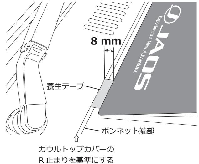
□ボンネットプロテクター①の貼り付け位置目安として、カウルトップカバーのR止まりから「8 mm」の位置がわかるように養生テープでマーキングします。
