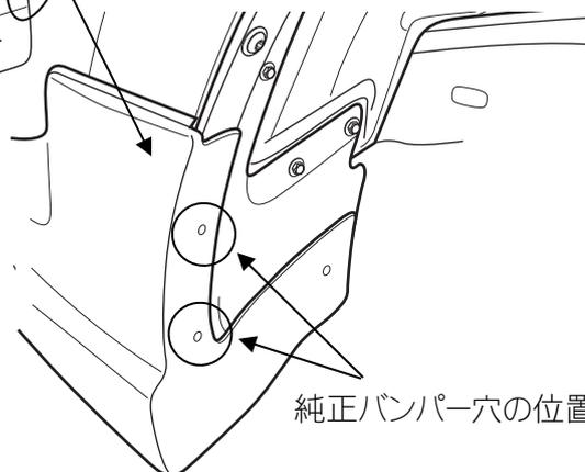
2.リヤスパッツ①を一旦取り外し、両面テープ接着面(ボディ側)を脱脂クリーナー⑨で脱脂する。
