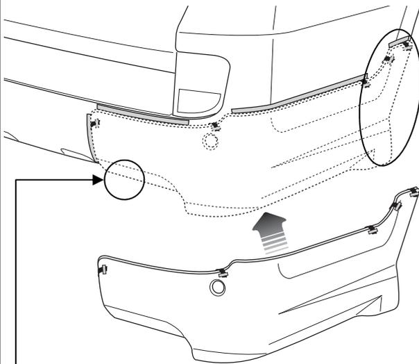
1.リヤスパッツ①を取付確認した位置に合わせて、サイド部及び下部を純正タッピング/タッピングM5-20②/タッピングM6-25③/トラスボルトM6-35④/フランジ付ナットM6⑤で仮固定する。
