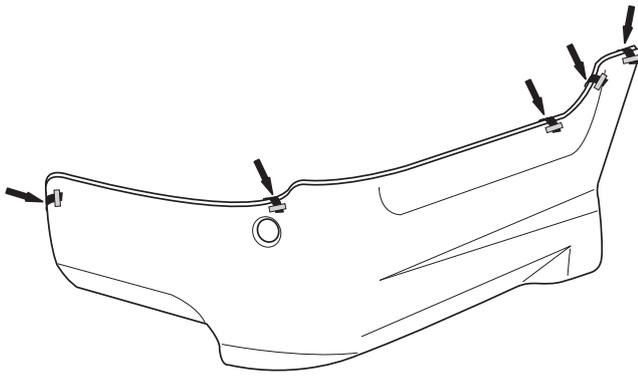
1.リヤスパッツ①に貼った両面テープの離型紙を一部剥がし、表面に折り返してマスキングテープで仮止める。
