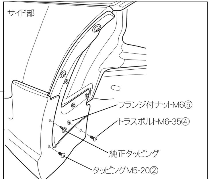
2.リヤスパッツ①の両面テープ離型紙を左図の矢印の方向に引き抜きながら圧着する。
