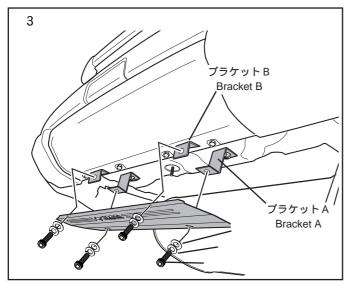
[3] 取り付けたブラケットA及びBにリヤスキットプレート本体 を六角穴付きボルト . スプリングワッシャー .平ワッシャー を使用して、仮止めしてください
