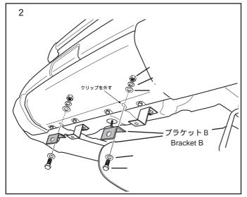
[2] バンパー下側のクリップを外し、図2のよう にブラケットB をボルト .平ワッシャー .スプリングワッシャー .六角ナット を 使用して仮止めしてください
