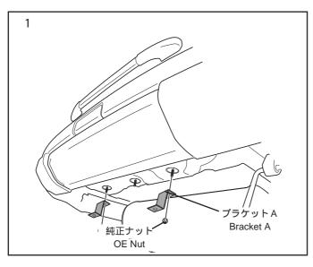
[1] 純正カバーを外して、図1のようにブラケットA を純正ナットを利用して仮止めしてください
