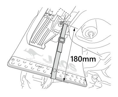
•ベルトをベルト吊りブラケット⑨へ取り付け、長さを 180mm (弊社推奨値) に調整します。
