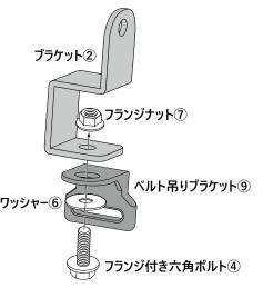
ブラケット②、フランジ付きボルト④、ワッシャー⑥、フランジナット⑦、ベルト吊りブラケット⑨を図のように組み立てます。
