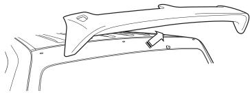
・純正リヤデフレクターが装着されている車両は取り外します。
