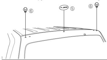
・純正リヤデフレクターの取付穴を埋めます。左右はフランジ付ボルト⑥を取り付けます。中央はエンブレム⑤を貼り付けます。
