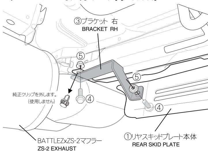
・リヤスキッドプレート本体①の取り付けに関係したバンパーを止めている純正クリップを取り外します。
