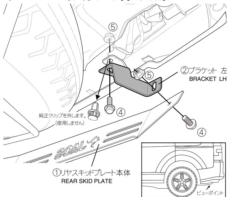
・リヤスキッドプレート本体①の取り付けに関係したバンパーを止めている純正クリップを取り外します。
