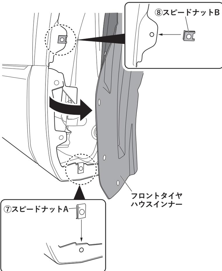
・フロントタイヤハウスイナーをめくり、車両クリップ穴に⑦スピードナットA（片側1ヶ所）、⑧スピードナットB（片側1ヶ所）を取り付けます。
