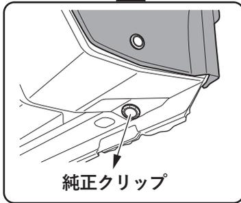
・フロントタイヤハウスイナーを留めているクリップ（片側4ヶ所）、タッピングスクリュー（片側1ヶ所）を取り外します。
